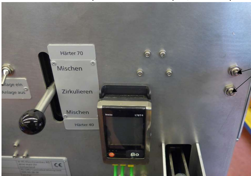
Interrupteur de pontage Il n'est pas nécessaire de les actionner tous les deux
