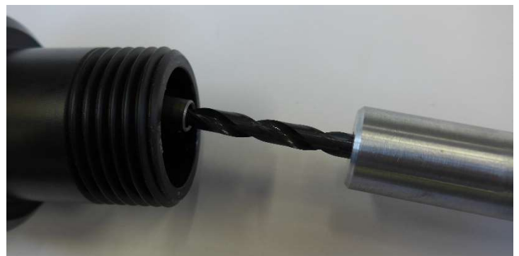
Reinigung der Härterdüse mit dem Reinigungsdorn
